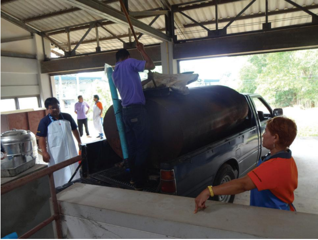
ภาพที่ 3 ปรับระดับ DRC ของน้ำยางสดให้ได้ 30%
