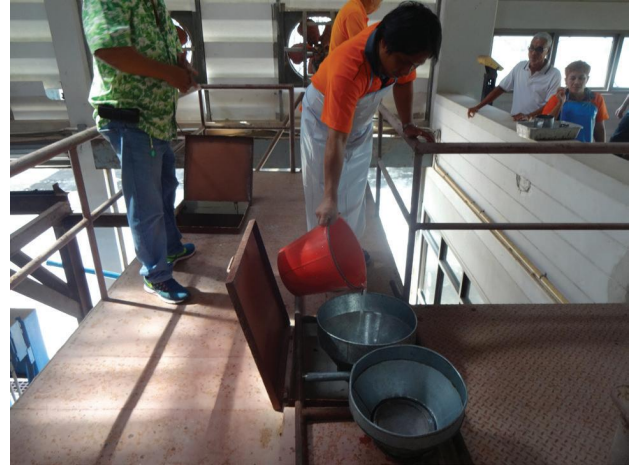
ภาพที่ 4 ควบคุมปริมาณแอมโมเนียก่อนปั่น
